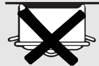
Il n'est pas recommandé d'utiliser un ustensile dont le fond est bombé, incurvé, ondulé ou déformé.
